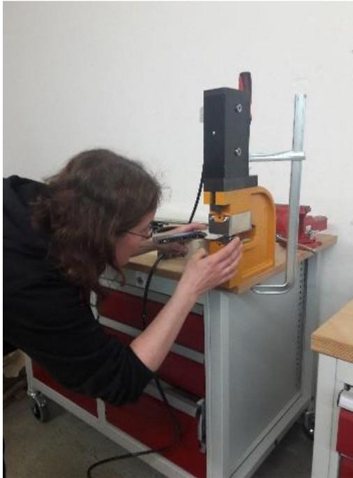
Nach vielem Ausloten, Planen und Diskutieren wurden heute die ersten Maschinen geliefert. Es handelt sich um pneumatische Stanzbügel, die zum Stanzen von Löchern in die Bauteile des Save80-Ofens eingesetzt werden.
