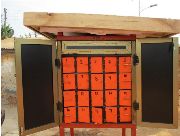
Bild 3: Die Boxen werden vermietet, damit in ihnen die Solarlampen und Handys sicher geladen werden können.
