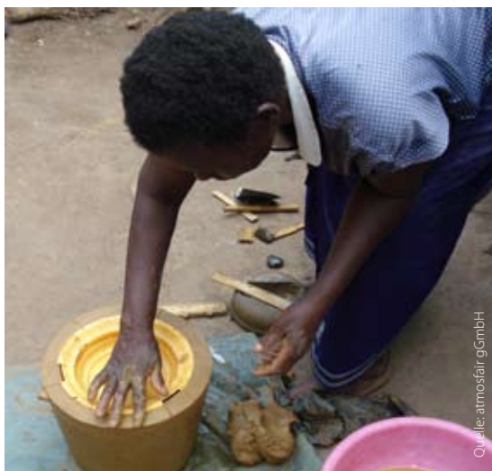
Bau eines Brennholzkochers aus Lehm in Malawi
