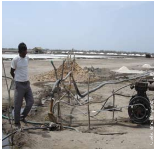
Wasserpumpe für die Salzgewinnung, deren Dieselverbrauch durch kleine technische Eingriffe sinkt
