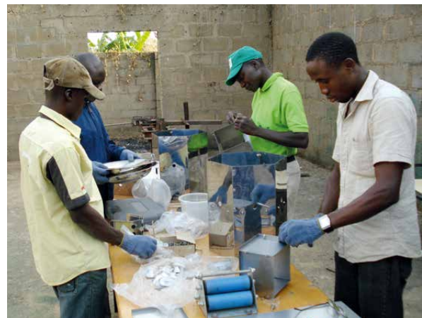
Montage von Save80-Öfen, Nigeria
