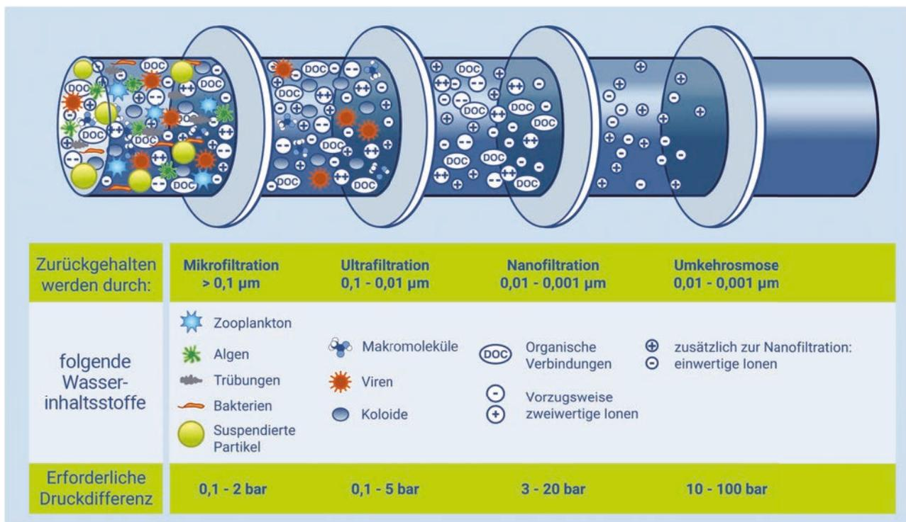
Membranfilter reinigen das Wasser mittels unterschiedlicher Druckbereiche, Quelle: Technologiezentrum Wasser (TZW)
