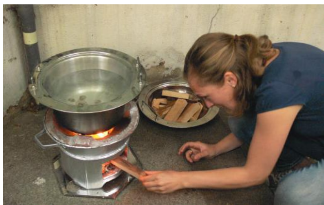
Der Dadin Kowa Stove wird vom atmosfair Team getestet
