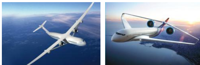
links: Vorbild Segelflugzeug; rechts: Boxwing
