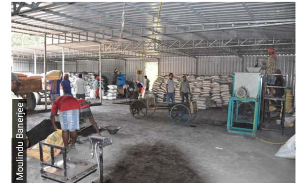
Buntes Treiben in der Anlage in Kaukepara. Die Kohle wird erst zerkleinert (blaue Maschine im Hintergrund), mit Hilfe einer Mix-Maschine (rechts) wird die zerkleinerte Pflanzenkohle mit Kompost vermischt und dann in Säcke gefüllt (vorne links)
