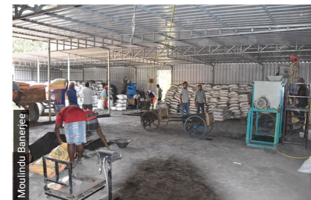
Buntes Treiben in der Anlage in Kaukepara. Die Kohle wird erst zerkleinert (blaue Maschine im Hintergrund), mit Hilfe einer Mix-Maschine (rechts) wird die zerkleinerte Pflanzenkohle mit Kompost vermischt und dann in Säcke gefüllt (vorne links)
