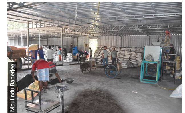
Buntres Treiben in der Anlage in Kaukepara. Die Kohle wird erst zerkleinert (blaue Maschine im Hintergrund), mit Hilfe einer Mix-Maschine (rechts) wird die zerkleinerte Pflanzenkohle mit Kompost vermischt und dann in Säcke gefüllt (vorne links)
