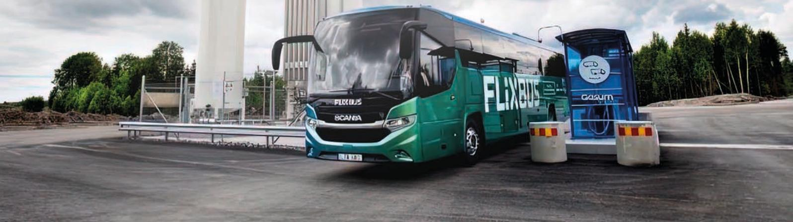
Der Gasbus von Scania, der in Schweden im Einsatz ist. Betankt wird der Bus ausschließlich mit Biomethan, das aus Abfallstoffen der Landwirtschaft gewonnen wurde. ©Scania
