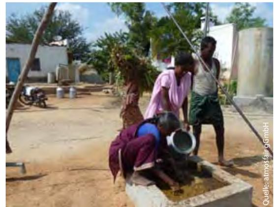
Die Klein-Biogasanlagen werden mit Kuhdung betrieben.
