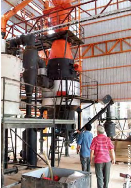
In dem Kraftwerk werden die Nussschalen in Gas umgewandelt.
